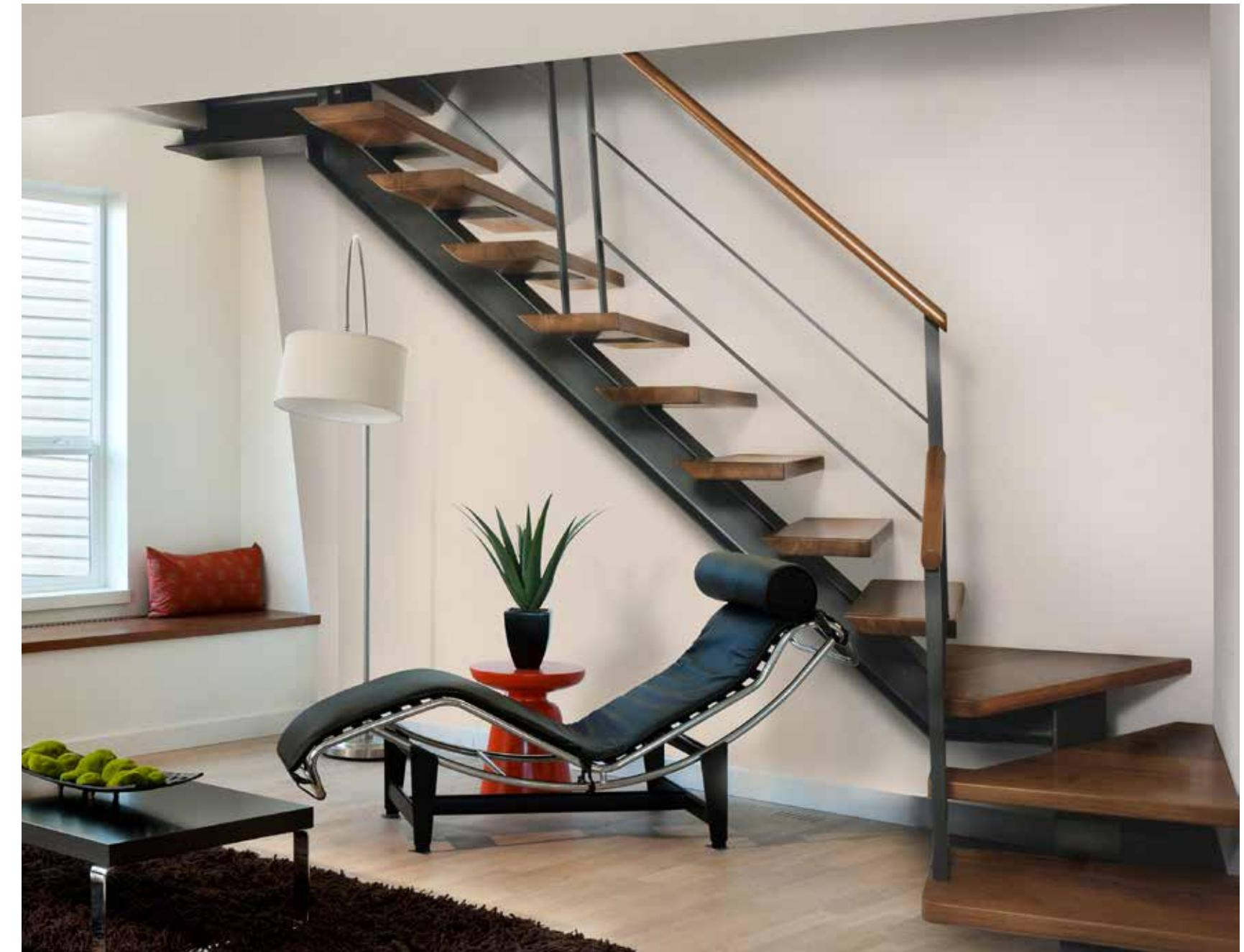
Scala elicoidale con struttura a fascia in acciaio colore ral e gradini in massello rovere e ringhiera in acciaio inox.
